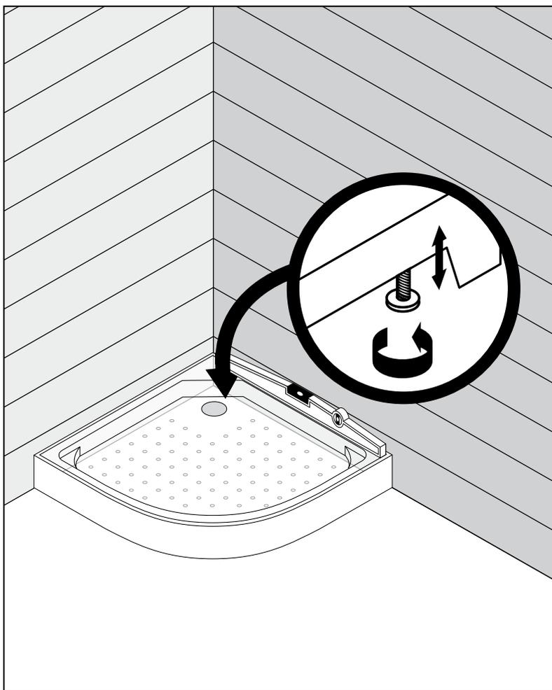
**A** - Après avoir déterminé l'emplacement de votre cabine intégrale et avoir procédé aux travaux préliminaires relatifs à l'arrivée et à l'évacuation de l'eau, positionnez le receveur et au besoin, réglez l'aplomb à l'aide des vérins réglables. Retirez les films de protection sur le receveur et les fonds thermoformés.
