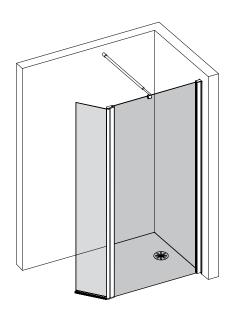
Note concernant la cheville fournie pour le réglage du mur, il convient de sélectionner la cheville adaptée à la structure de votre mur : PLACO / PLATRE / BETON / CARRELAGE / BRIQUE... ASSUREZ-VOUS DE LA BONNE POSITION DES PROFILÉS AVANT DE PERCER.
