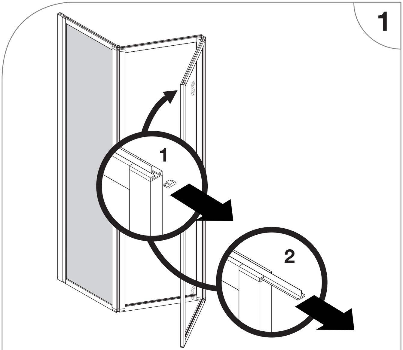
Déclipsez le bloqueur à l'extrémité du pare baignoire et récupérez le joint en le faisant glisser vers l'extérieur. Si ce dernier vous semble hors d'usage, il est préférable d'en commander un nouveau auprès de notre service après-vente.
