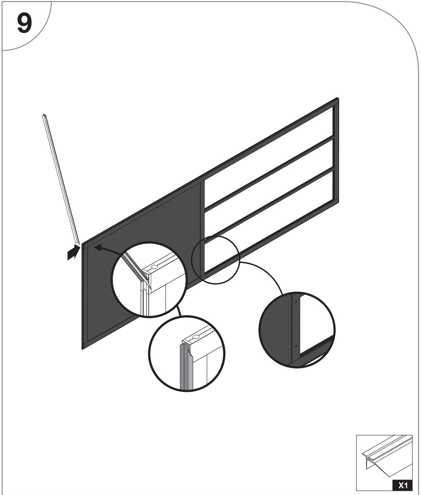
Glissez le joint dans la rainure du bas de porte en veillant à placer la partie déflecteur du côté intérieur.
