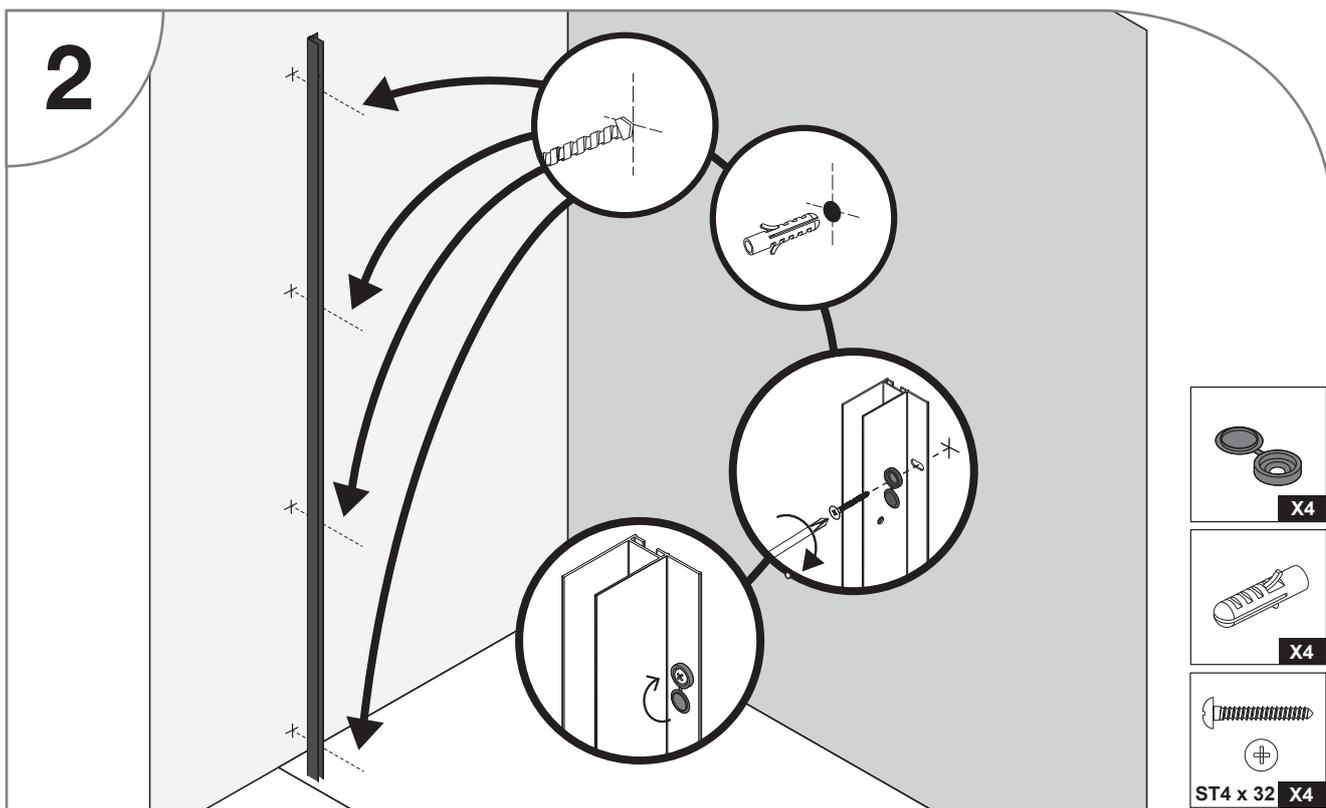
Percez les trous à l'aide d'un forêt adapté à votre mur (non-fourni). Fixez le profilé au mur à l'aide de chevilles et de vis adaptées à votre mur.
