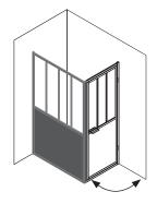
Pour commencer, positionnez le profilé mural sur votre mur à l'emplacement souhaité et repérez les trous en vérifiant l'aplomb à l'aide d'un niveau à bulle.
