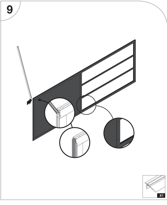
Glissez le joint dans la rainure du bas de porte en veillant à placer la partie déflecteur du côté intérieur.
