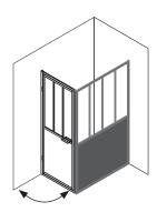
Pour commencer, positionnez le profilé mural sur votre mur à l'emplacement souhaité et repérez les trous en vérifiant l'aplomb à l'aide d'un niveau à bulle.
