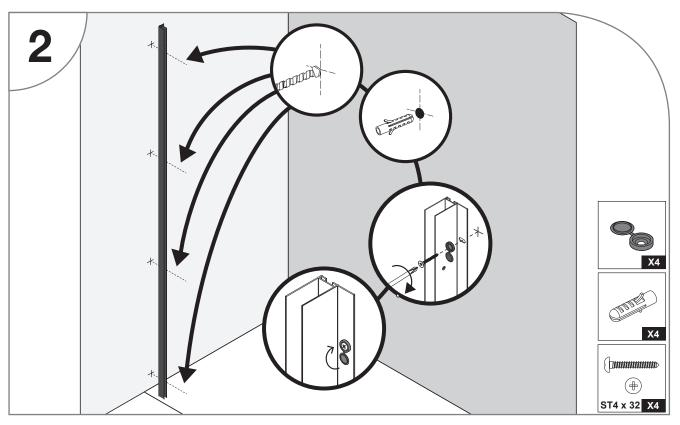
Perçez les trous à l'aide d'un forêt adapté à votre mur (non-fourni). Fixez le profilé au mur à l'aide de chevilles et de vis adaptées à votre mur.
