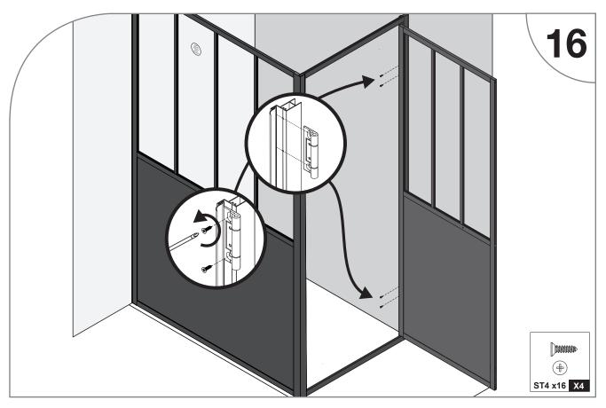
Engagez les charnières dans la rainure de l'encadrement, en veillant au bon alignement des perçages. Vissez les charnières sur l'encadrement.
