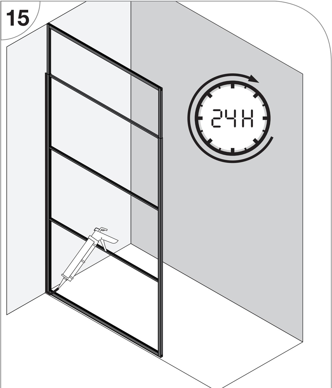
Afin d'assurer une étanchéité totale, nous conseillons de silicuner la jonction extérieure entre le mur et le profilé sur toute sa hauteur. Utiliser du silicone sanitaire bactéricide et fongicide afin de garantir sa tenue dans le temps.
