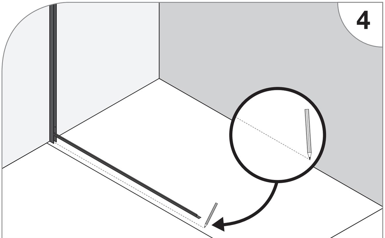
Une fois la baguette bien positionnée, tracez une ligne sur le sol.
