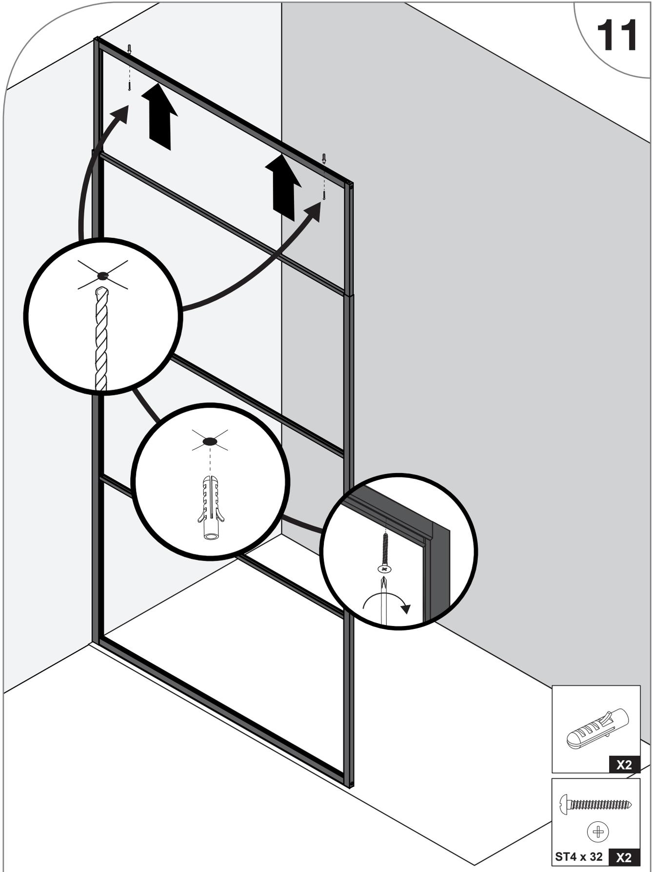
Rabaissez l'encadrement supérieur en position initiale avant de percer.
