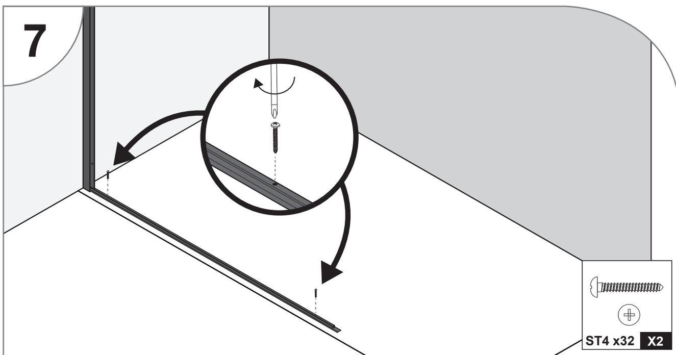
Vissez la baguette d'étanchéité au sol en veillant à ne pas la déformer.
