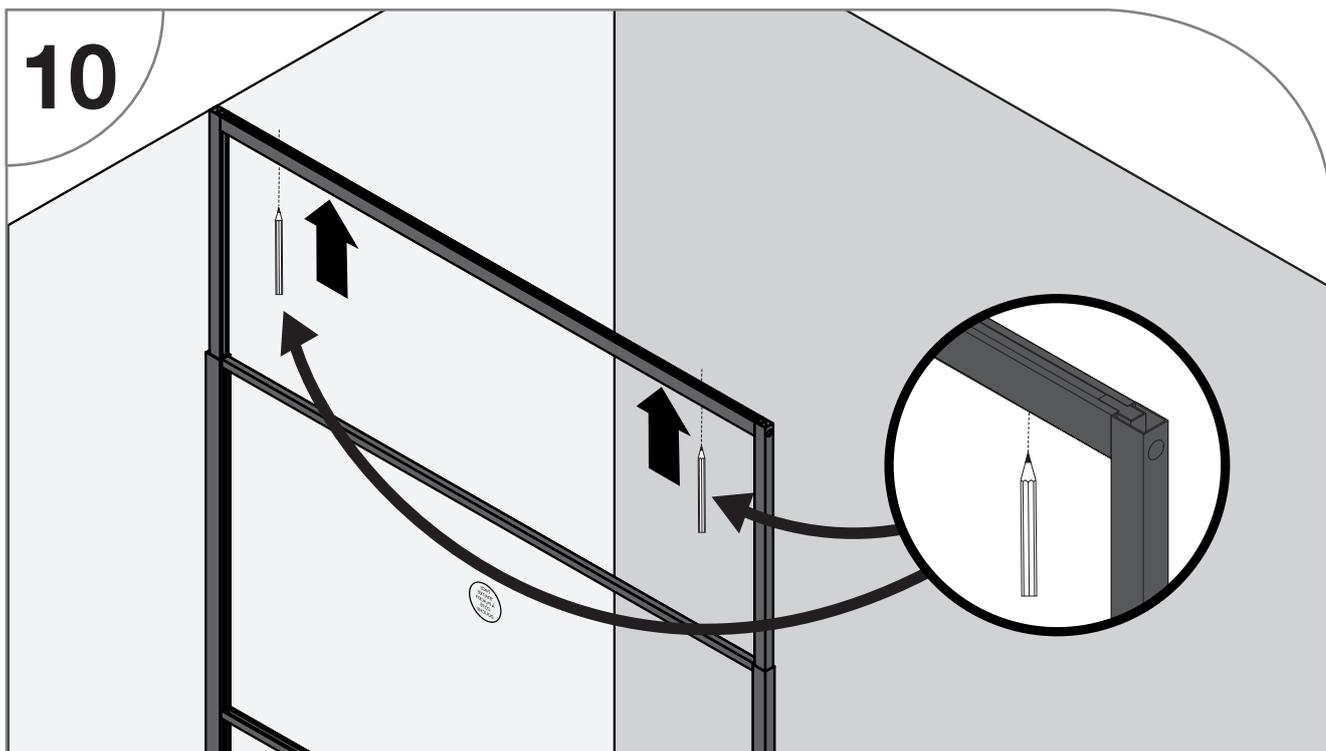
Etirez l'encadrement supérieur jusqu'au plafond et repérez les 2 perçages.
