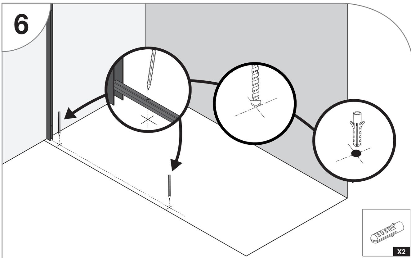
Si besoin, une fixation par vissage dans le sol peut être fait en complément de l'utilisation de silicone. Vérifiez que les chevilles fournies soient adaptées à la nature de votre support.
