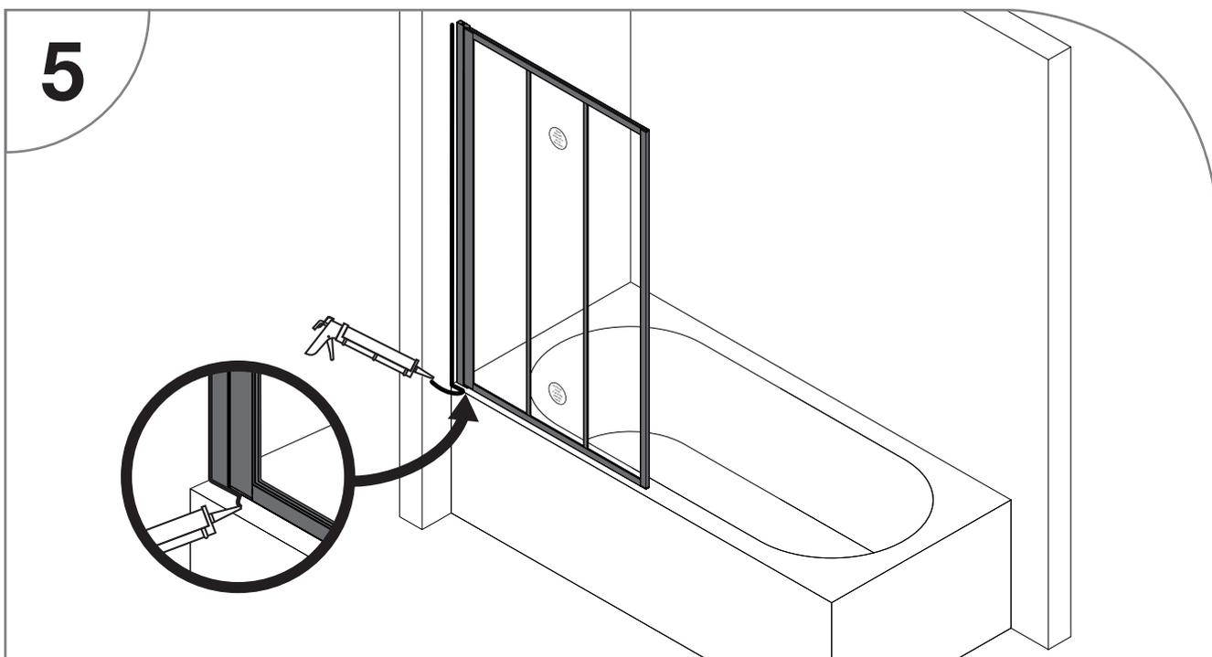
Afin d'assurer une étanchéité totale, nous conseillons de siliconer la jonction extérieure entre le mur et le profilé sur toute sa hauteur. Utilisez du silicone sanitaire bactéricide et fongicide afin de garantir sa tenue dans le temps.
