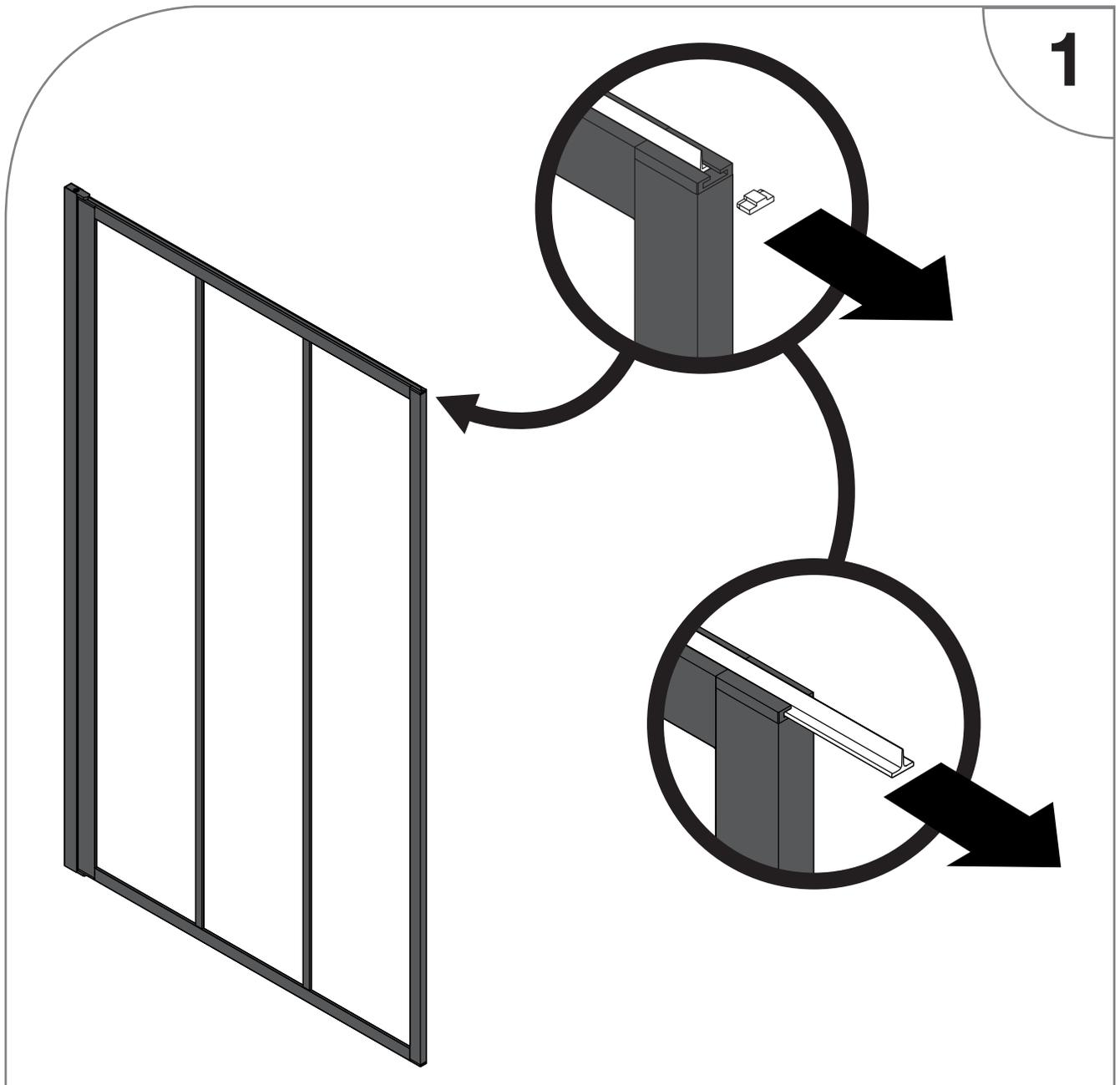
Déclipsez le bloqueur à l'extrémité du pare baignoire et récupérez le joint en le faisant glisser vers l'extérieur. Si le joint vous semble hors d'usage, il est préférable de commander une nouvelle pièce auprès de notre service après-vente.
