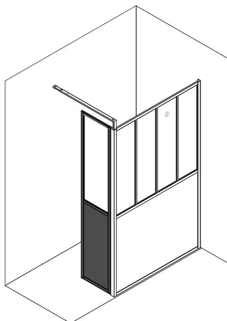
Le montage d'une paroi ARTELO est nécessaire en amont de la fixation du déflecteur. Vous avez la possibilité de réaliser un montage du déflecteur sur la gauche ou la droite de votre paroi. Nos instructions de montage décrivent uniquement un montage à gauche à partir de l'étape 2. Si vous voulez réaliser un montage à droite, il vous suffit d'inverser le sens.
