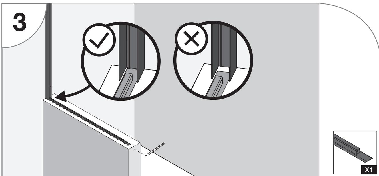
Positionnez la baguette d'étanchéité sur votre muret en contrôlant les points suivants :
