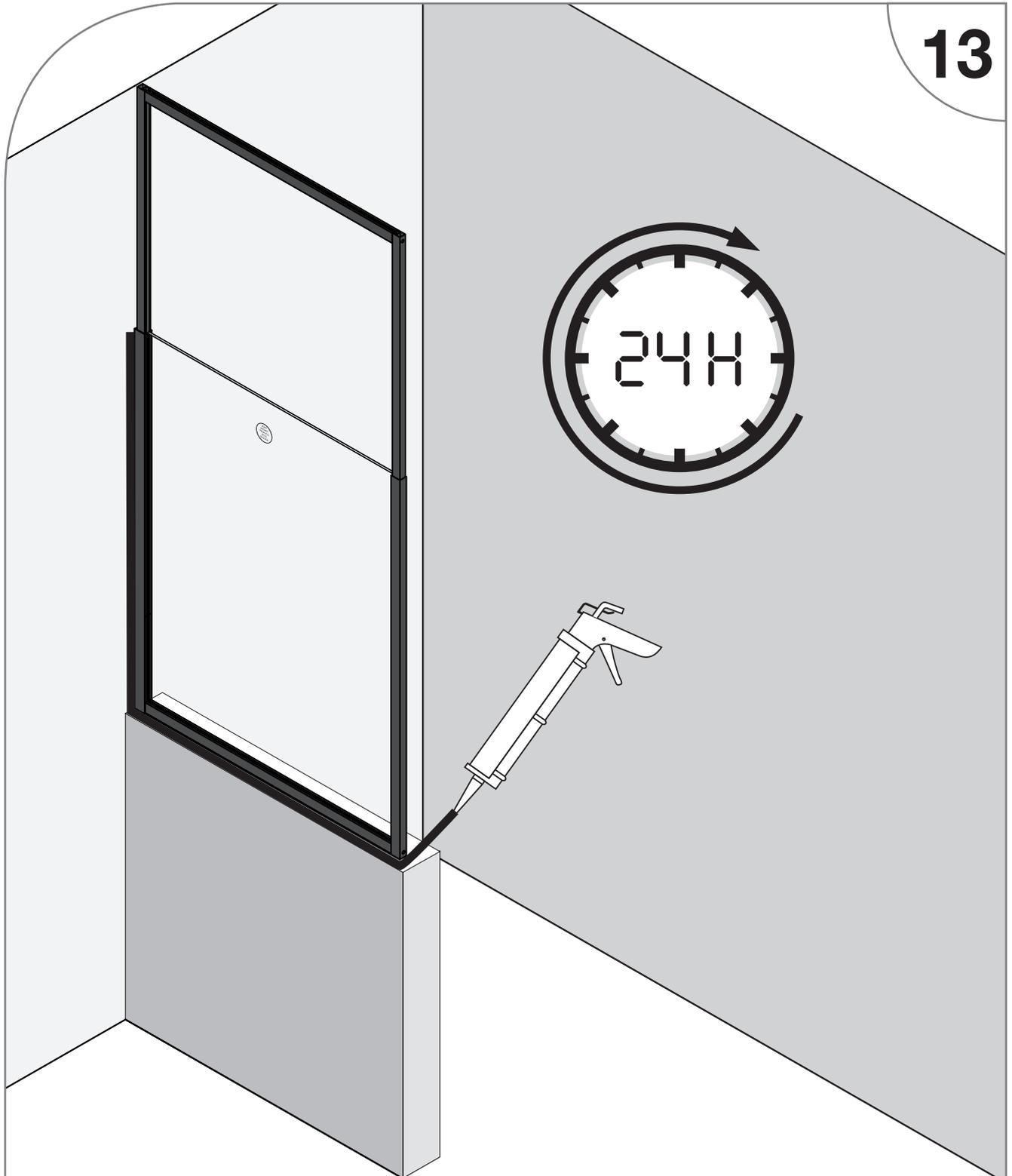
Afin d'assurer une étanchéité totale, nous conseillons de silicuner la jonction extérieure entre le mur, le muret et les profilés. Utiliser du silicone sanitaire bactéricide et fongicide afin de garantir sa tenue dans le temps.
